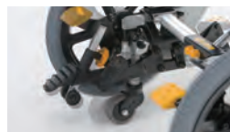
リフトアップ機構 リフトアップキャスタを下げることによって車輪が浮き、真横への移動や旋回が可能。ベッドへの乗降時や、狭い廊下での通行に便利です。
